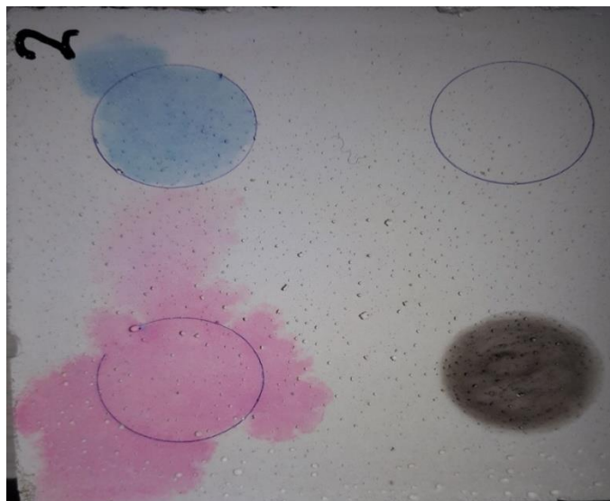
شکل ۳: سطح نمونه بتنی آغشته شده با ماده آلوده کننده دوده (مشکی)، رودامین B (صورتی) و متیلن (آبی) برای آزمایش بر روی رنگ سطح بتن نمونه حاوی نانوسلیس با ۲/۵ درصد دی اکسید تیتانیوم در شروع آزمایش.
