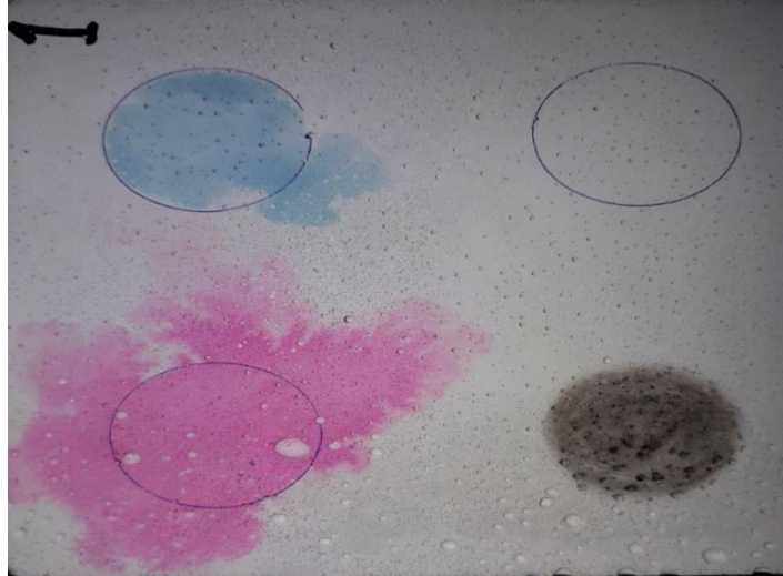
شکل ۱: - سطح نمونه بتنی آغشته شده با ماده آلوده کننده دوده (مشکی)، رودامین B (صورتی) و متیلن (آبی) برای آزمایش بر روی رنگ سطح بتن نمونه حاوی نانوسلیس در شروع آزمایش بدون افزودن دی اکسید تیتانیوم.
