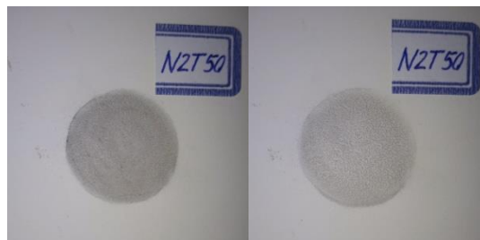
شکل ۷- مقایسه استفاده از ۵ درصد دی اکسید تیتانیوم با ۲ درصد نانوسلیس برای خاصیت خودتمیزشوندگی در بتن قبل و بعد از تاثیر ۲۴ ساعته اشعه فرابنفش و شکل سمت راست قبل از تاثیر اشعه فرابنفش و شکل سمت چپ بعد از ۲۴ ساعت استفاده از اشعه فرابنفش می باشد.
