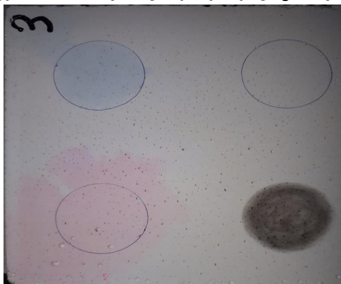
شکل ۶- سطح نمونه بتنی آغشته شده با ماده آلوده کننده دوده (مشکی)، رودامین B (صورتی) و متیلن (آبی) برای آزمایش بر روی رنگ سطح بتن نمونه حاوی نانوسلیس با ۵ درصد دی اکسید تیتانیوم بعد از گذشت زمان ۲۴ ساعت.
