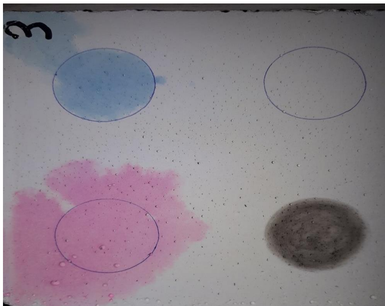
شکل ۵- سطح نمونه بتنی آغشته شده با ماده آلوده کننده دوده (مشکی)، رودامین B (صورتی) و متیلن (آبی) برای آزمایش بر روی رنگ سطح بتن نمونه حاوی نانوسلیس با ۵ درصد دی اکسید تیتانیوم در شروع آزمایش.
