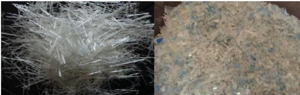
شکل ۱: خرده های بازیافتی PET ( سمت راست) و خرده های الیاف شیشه ( سمت چپ )
