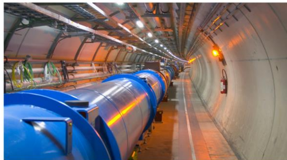
شکل شماره ۲. نمایش تونل LHC و سرماسنج مغناطیسی در یک بخش قوسی.
