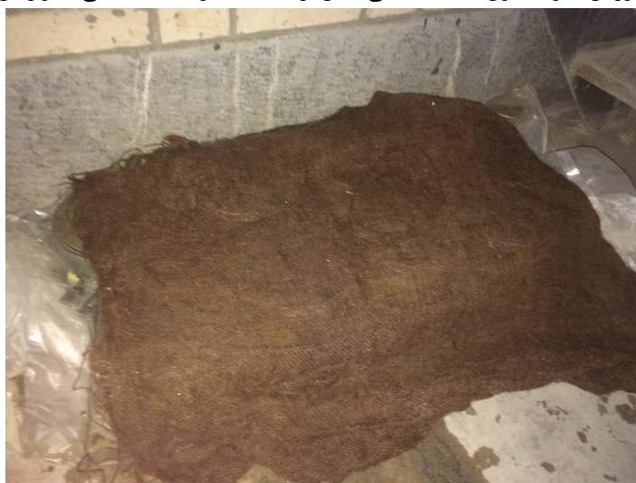
شکل ۲-۴- نگهداری نمونه‌های تثبیت شده با سیمان
