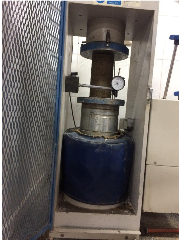
شکل ۲-۵- نمونه تثبیت شده با سیمان تحت بارگذاری در دستگاه تک محوری
