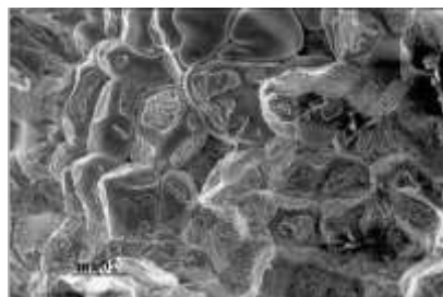
شکل ۲. تصویر SEM از سطح شکست کامپوزیت با ۹٪ حجمی ذرات تقویت کننده SiC [۴]
