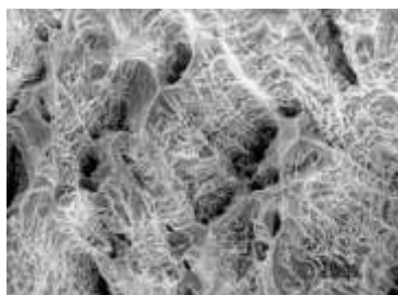
شکل ۱. تصویر SEM از سطح شکست آلیاژ آلومینیوم [۴]
